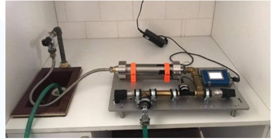
Farklı basınçlarda IPS ile işlenmiş suyun bitki büyümesi üzerindeki etkisini ölçmek için araştırmacılar tarafından geliştirilen bir cihaz.
